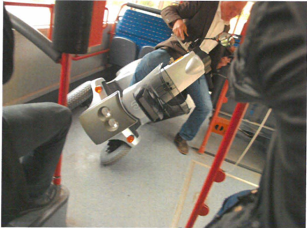
Bild 9: Kippendes Elektromobil mit Aufsasse bei Kurvenfahrt
