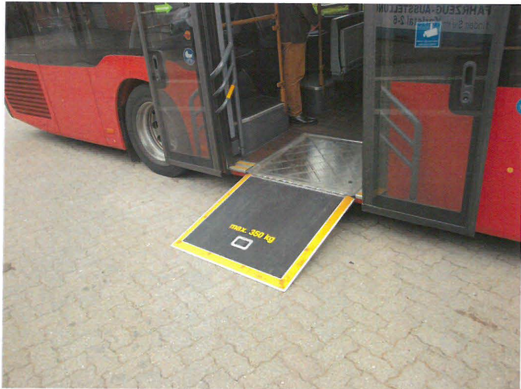
Bild 5: Einstiegsrampe, zulässige Belastung 350 kg
