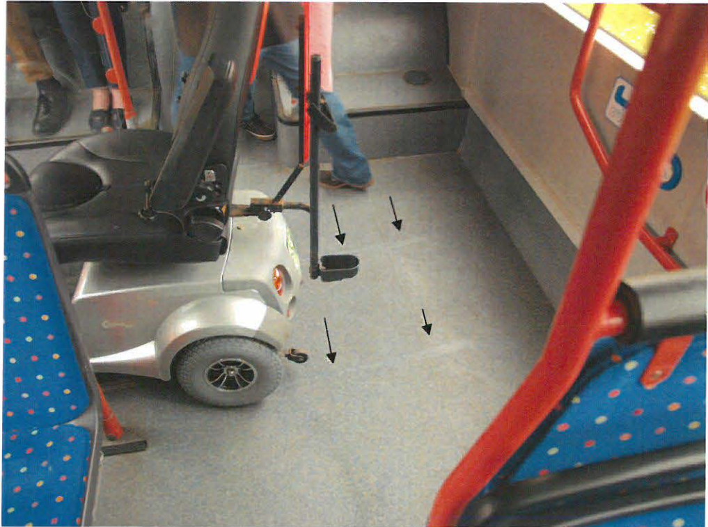
Bild 13: Rutschspuren nach Kurvenfahrt bei Positionierung des Elektromobils quer zur Fahrtrichtung
